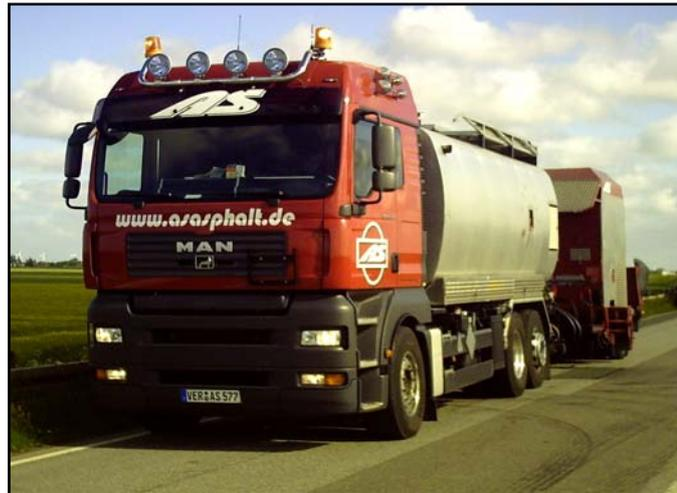
Der Reparaturzug / Roadmaster bietet die Möglichkeit, erforderliche Erhaltungsmaßnahmen zur Sanierung von Asphaltdeckschichten mittels partieller Oberflächenbehandlung wirtschaftlich durchzuführen.
